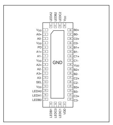
Pin Configuration (42-TQFN ZL, Top-Side View)
